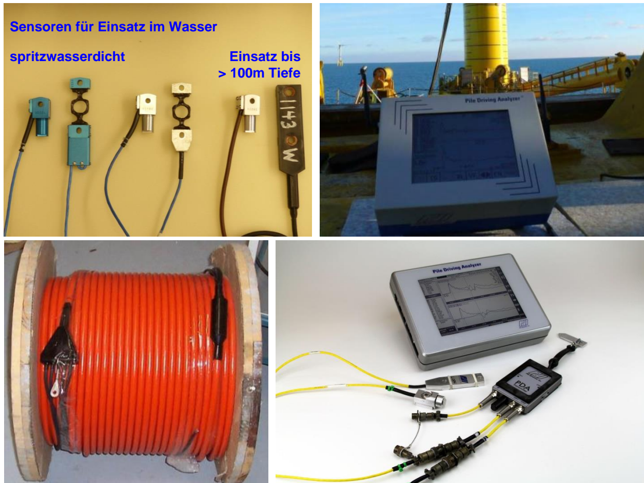
Abbildung 5: Sensoren, Messkabel und Messgerät (Pile Driving Analyzer) zum Monitoring der Rammung und zur Durchführung von Restrike Tests - offshore und onshore
